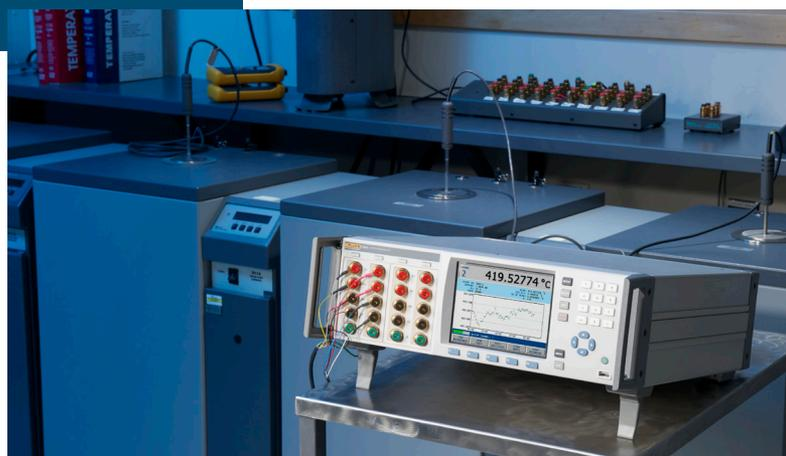
интерфейсом, который значительно упрощает его использование (по сравнению с использованием моста). В отличие от мостов, которые отображают только коэффициент, устройства 1594A и 1595A предусматривают возможность выбора способа отображения результатов: в коэффициентах (Rx/Rs), Ом, °C, °F, K.
