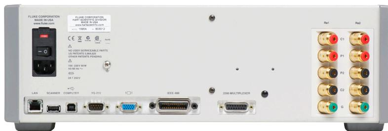
Два входа эталонного резистора на задней панели позволяют использовать каналы на передней панели для подключения эталонных термометров и испытуемых устройств.
