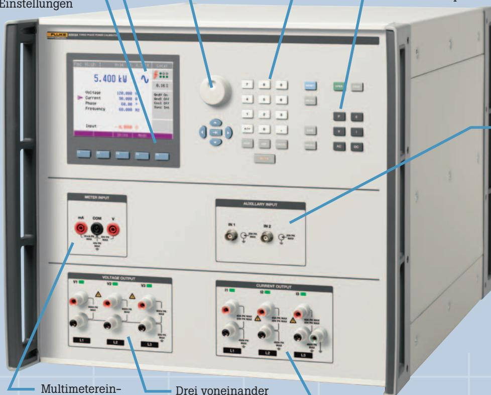
Optionaler 1-MHz-Zählereingang zum Prüfen von Energiezählern. Synchronisationseingang zur Schaffung eines Vierphasensystems bei Verwendung des Kalibrators 6100 von Fluke Calibration.
