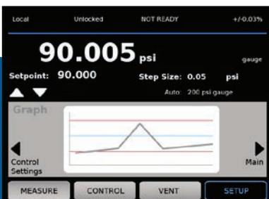
Le graphique en temps réel permet d'observer facilement la stabilité de la pression et l'état des procédures.
