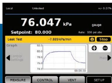
Les tests de fuite intégrés simplifient le processus de validation d'intégrité du système.
