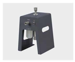
O Sistema de Prevenção contra Contaminação funciona como uma bancada de teste para a conexão de unidades sob teste e também para evitar que a contaminação alcance o 6270A.
