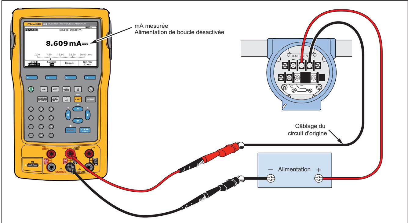
**Figure 47. Courant de sortie d'une mesure de transmetteur**
