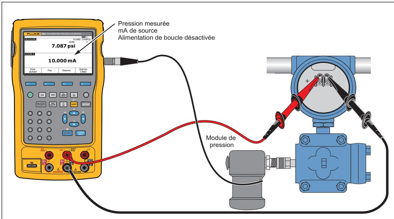
Figure 46. Étalonnage du transmetteur courant à pression (I/P)
