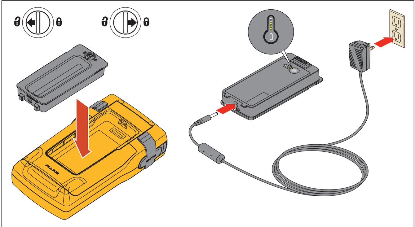
Figure 8. Retrait de la batterie et utilisation du chargeur
