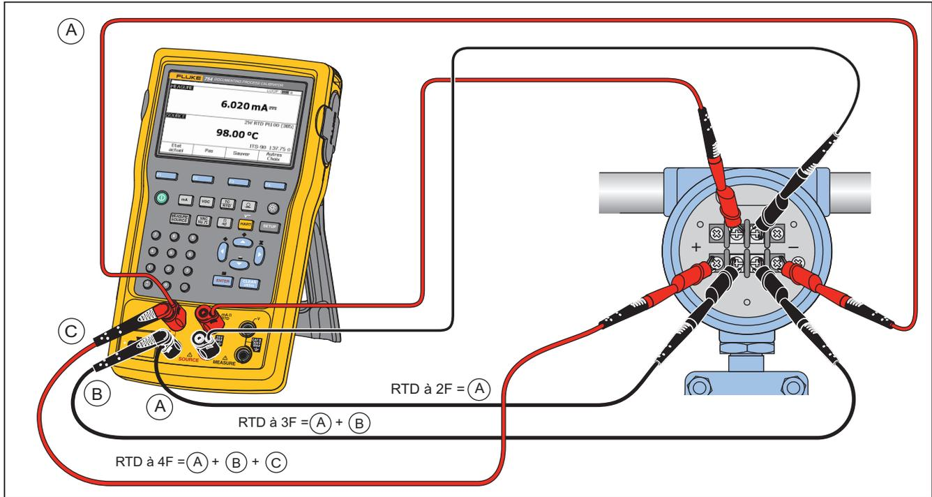
Figure 55. Connexions du transmetteur RTD HART et analogique
