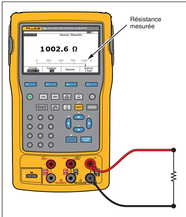
Figure 48. Mesure de la résistance de précision
