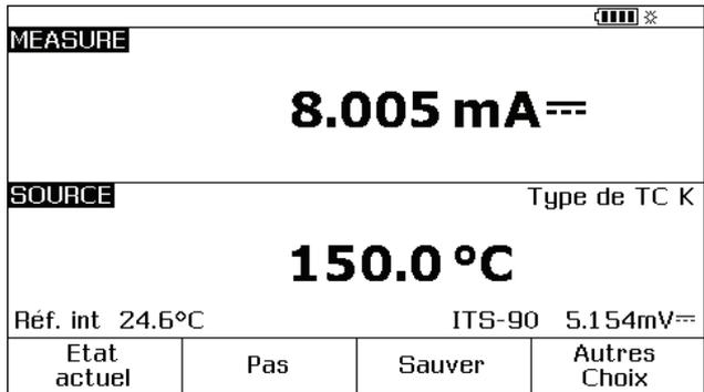
Figure 27. Écran de mesure et de source
