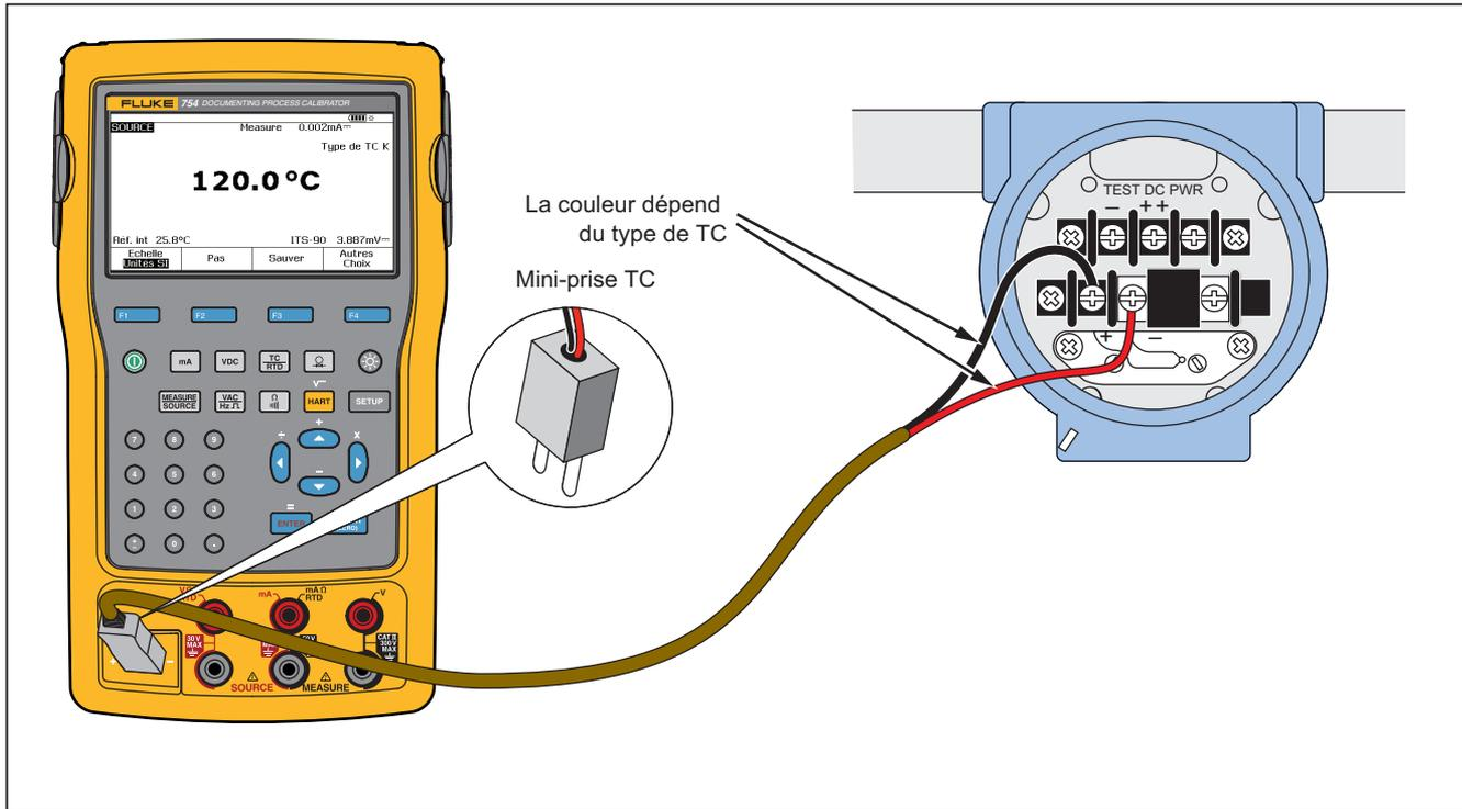
Figure 22. Connexions pour simuler un thermocouple
