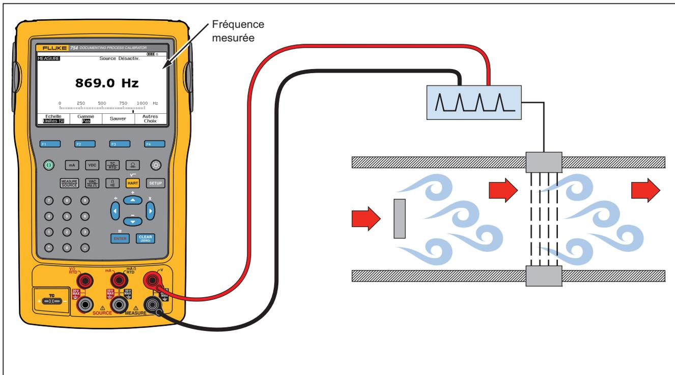
Figure 54. Vérification du débitmètre à tourbillons de Kármán
