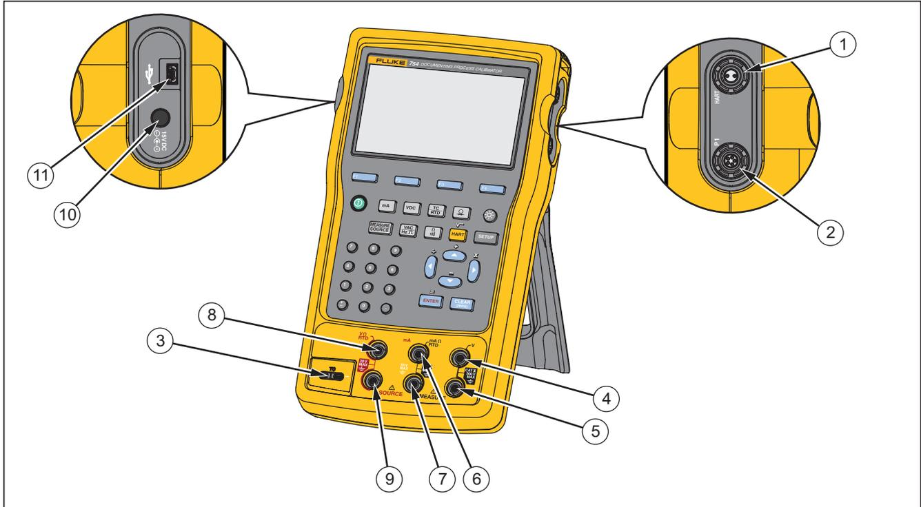
**Figure 4. Jacks et connecteurs d'entrée/sortie**
