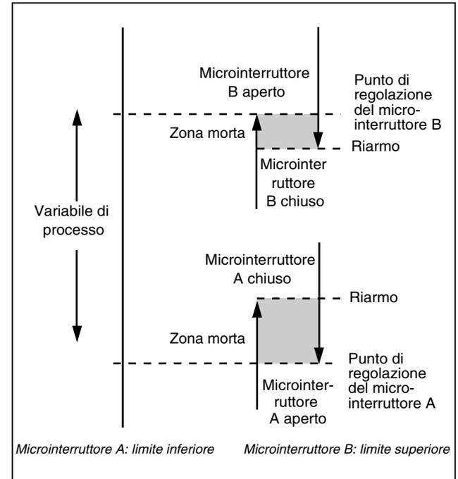
**Figure 35. Terminologie d'un commutateur**
