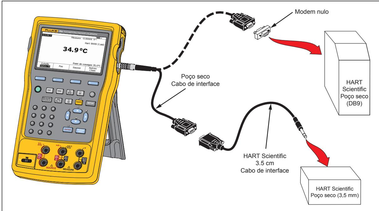
**Figure 24. Température de source avec le puits sec**
