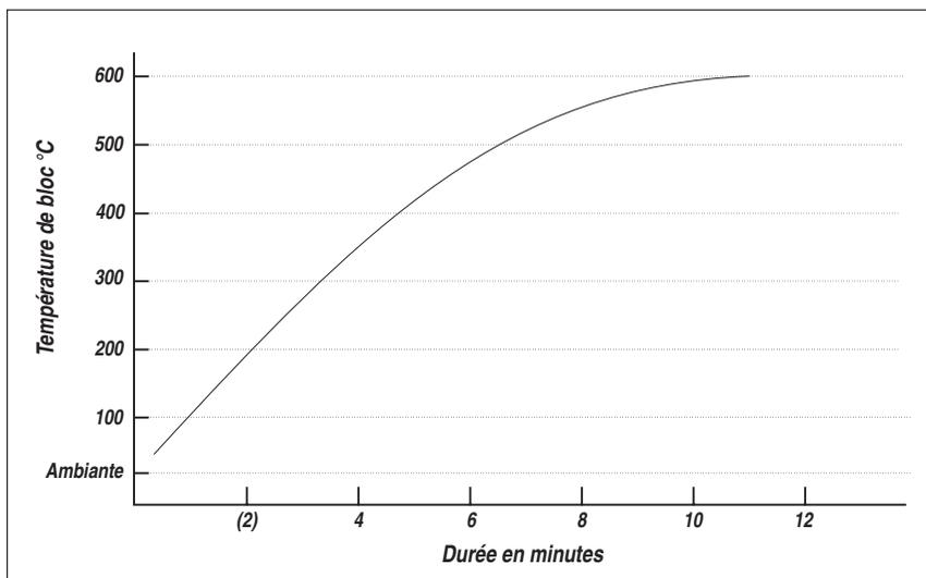
Figure 7 Vitesse de chauffage typique
