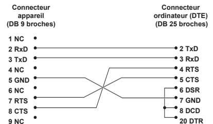
Figure 6 Configuration du câble série
