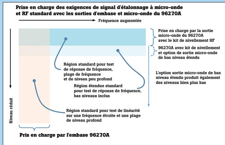
En général, les signaux requis pour l'étalonnage des RF et des micro-ondes se divisent en deux plages : une plage relativement étroite de fréquences basses sur une plage de grande amplitude et une amplitude relativement importante de basses à très hautes fréquences.
