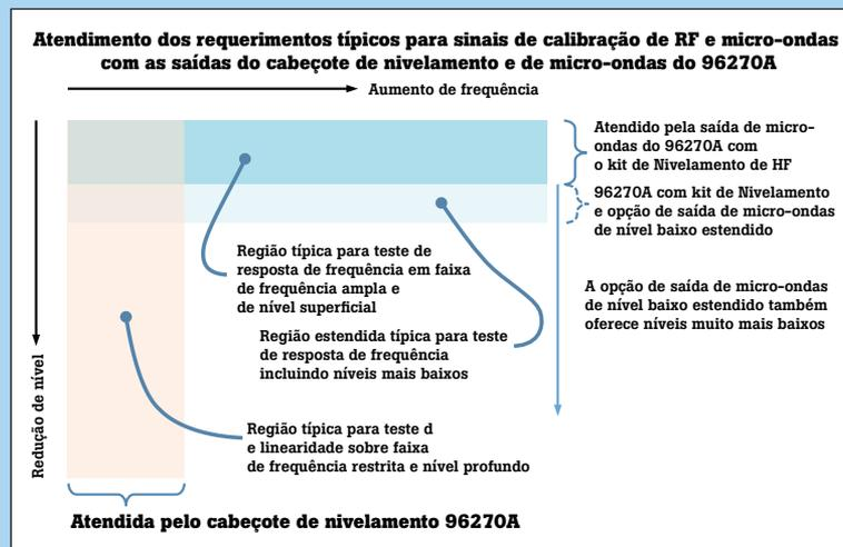
Normalmente, os sinais necessários para calibração de RF e de micro-ondas podem ser divididos em duas faixas: em uma faixa relativamente estreita de frequências baixas sobre uma ampla faixa de amplitude; e em amplitudes relativamente altas de frequências baixas a muito altas.
