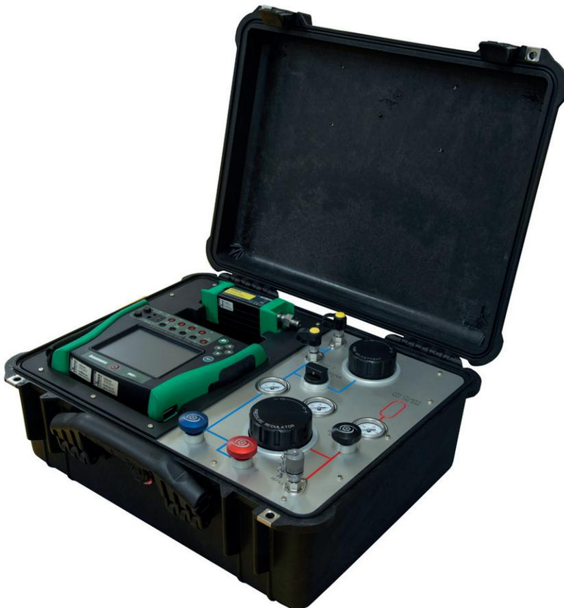
Eigenständiges System zur Kalibrierung und Prüfung von pneumatischem Druck bis zu 250 bar auf Basis des Multifunktionskalibrators Beamex MC6 mit Druckmodulen.
