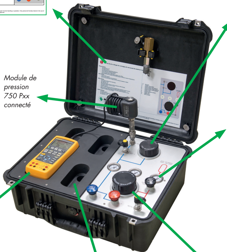
Le dispositif de réglage du volume de précision MNR 90 de Minerva permet un réglage très fin de la pression jusqu'à 100 Pa
