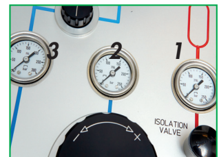
Les trois manomètres indiquent: 1. la pression dans la bouteille 2. la pression établie par le régulateur de pression 3. la pression au niveau du raccord de la voie de mesure
