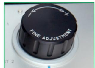
Der präzise variable Volumeneinsteller Minerva MNR 90 ermöglicht eine sehr feine Druckeinstellung bis hinunter auf 100 Pa
