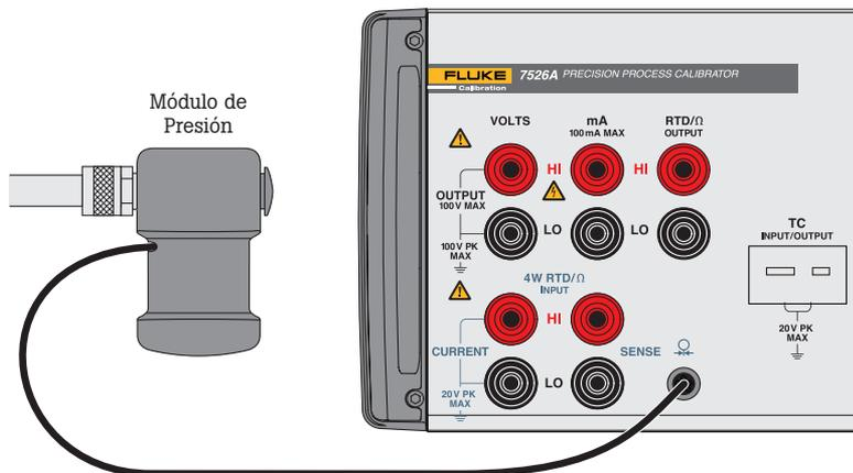
Figura 3. Conexión del módulo de presión.
