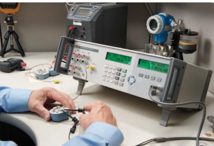
Calibración de transmisores de termopar
