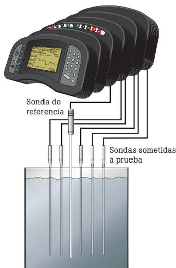
En este ejemplo, todas las sondas se conectan directamente al lector del termómetro, un modelo 1560 Black Stack de Hart Scientific. El lector controla la medida y explora todas las sondas que realizan
