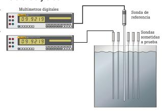
La sonda de referencia se conecta a un lector y la primera sonda a calibrar se conecta al segundo lector. De esta forma, las sondas que se van a medir reciben corriente en todo momento, con lo que se eliminan los errores de autocalentamiento causados por los cambios de la corriente. Las sondas a calibrar se conectarán y se medirán individualmente.
