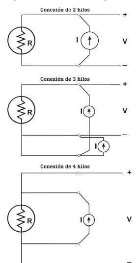
Figura 1. Esquema de conexiones del lector del termómetro.
