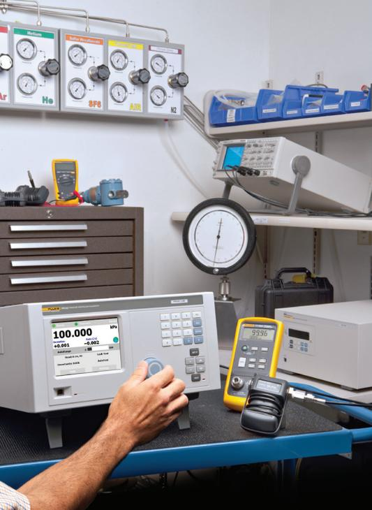
El PPC4E calcula y muestra la incertidumbre de la presión suministrada o medida de forma continua. El cálculo utiliza componentes de incertidumbre en función de las especificaciones del PPC4E y el usuario puede personalizar los valores de componentes.
