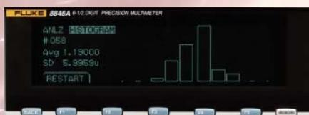
Prüfen Sie die Ergebnisse im Histogramm-Modus, um Stabilitäts- oder Rauschprobleme in analogen Schaltungen zu erkennen
