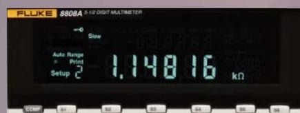
Über die Tasten auf der Frontplatte können sechs häufig benötigte Messungen eingerichtet werden. Mit einem einfachen Knopfdruck auf die entsprechende Taste lässt sich die gewünschte Messung aktivieren.
