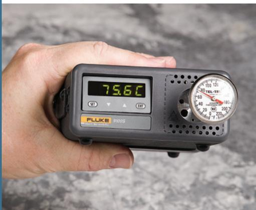
Les capteurs de température sont faciles à étalonner avec un four sec portatif.
