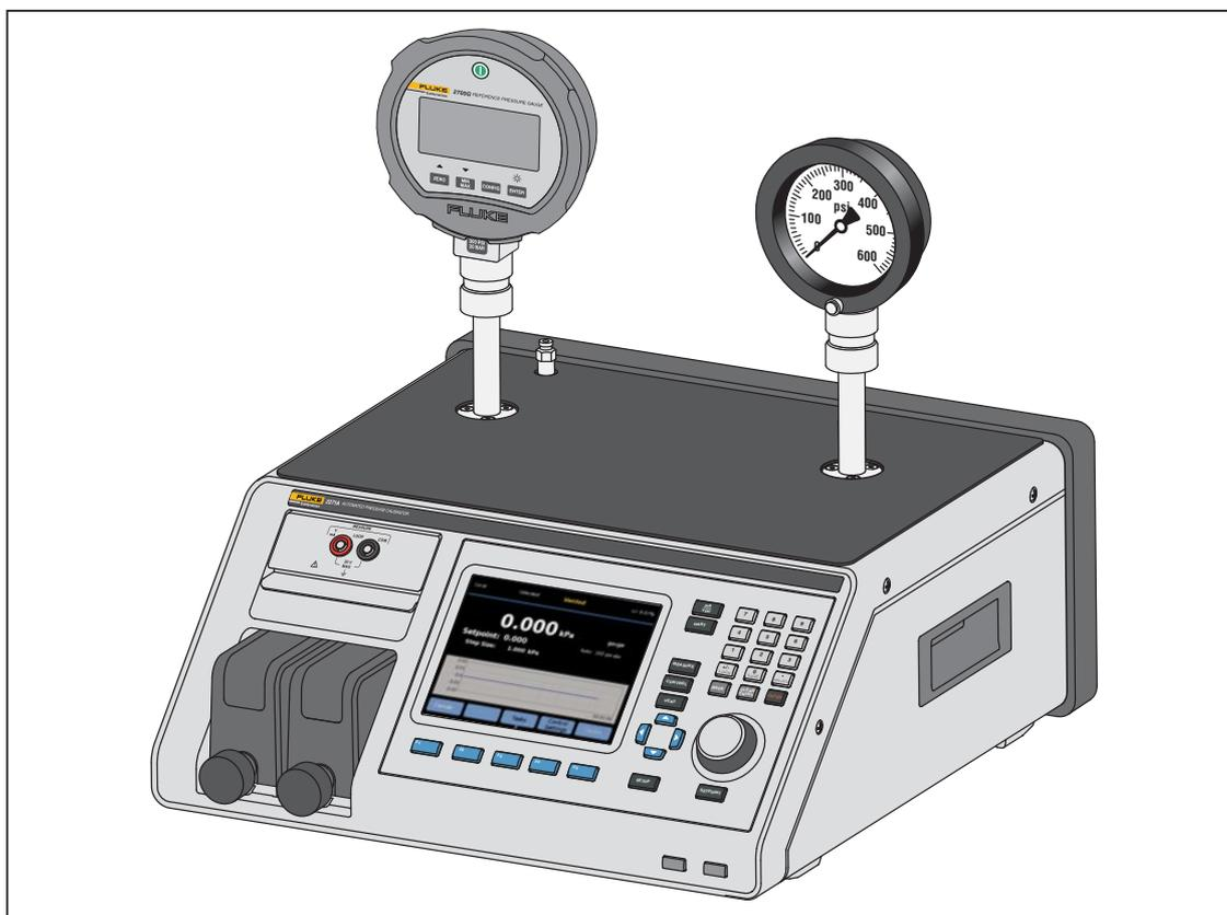
図 4. 2 つの圧力計を接続
