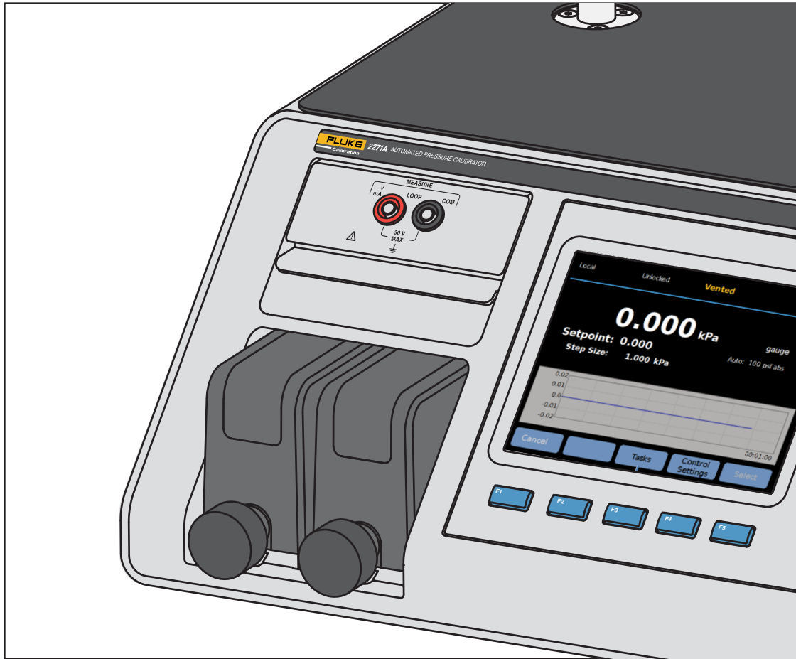
그림 3. 설치된 EMM 및 PMM 모듈
