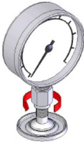
Abbildung 2-2. Baugruppe am Prüfanschluss anschließen
