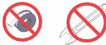
Figura 2-3. Não aperte em excesso
