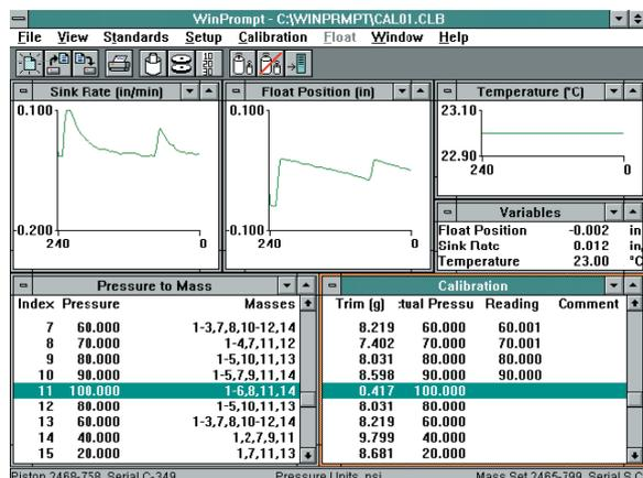
WinPrompt erfasst die Informationen vom Kolbenmanometer über den Kolbenmanometer-Monitor und zeigt sie in Echtzeit an. Die Daten werden anschließend zur automatischen Einstellung der Druck/Masse-Werte verwendet.
