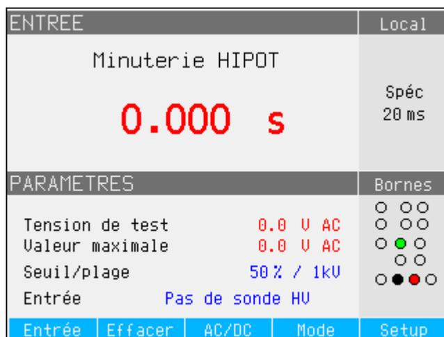
Figure 26. Affichage du multimètre avec mesure de la minuterie du testeur de sécurité haute tension
