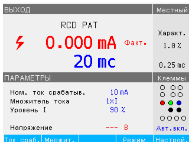
Рисунок 18. Калибровка времени срабатывания УЗО в PAT
