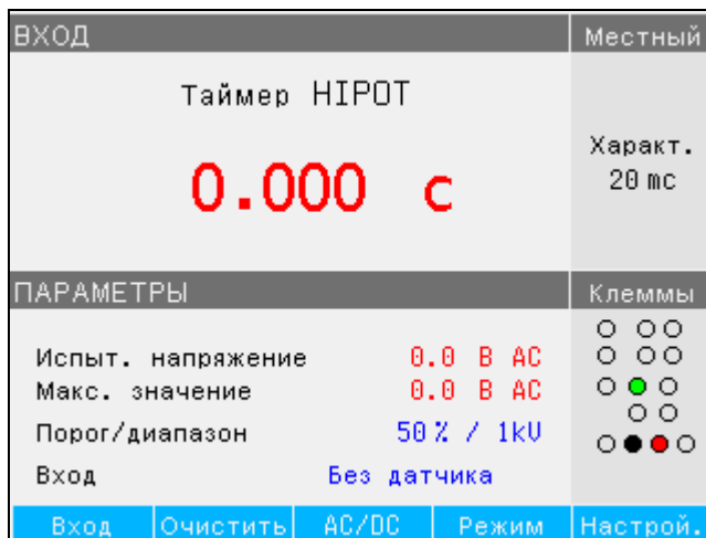
Рисунок 26. Экран мультиметра с измерением таймера высоковольтного тестера электробезопасности
