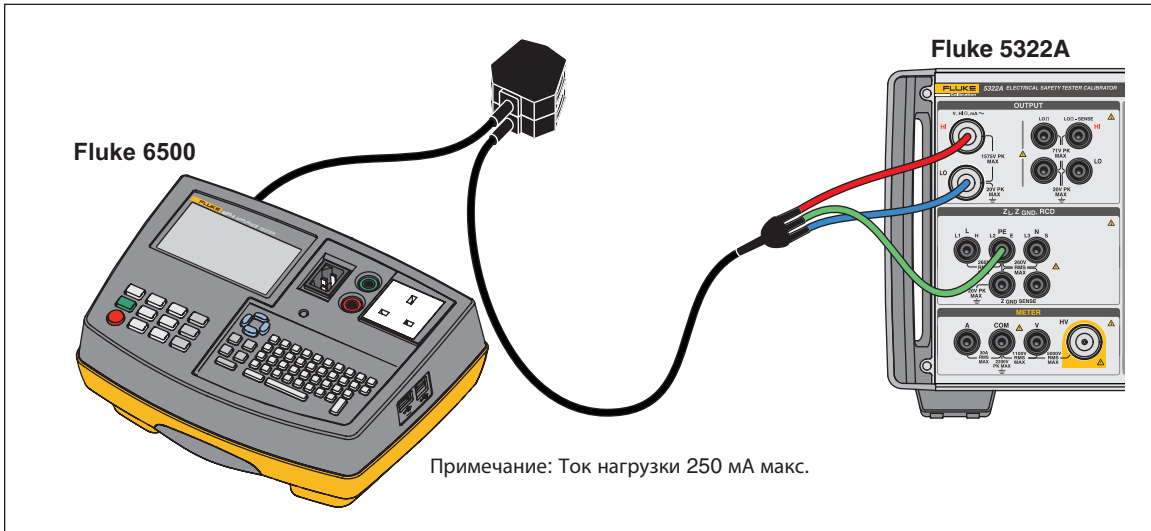
Рисунок 53. Калибровка напряжения на тестерах электробезопасности с питанием от сети
