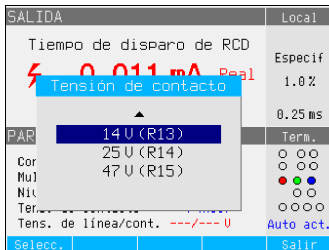
Figura 16. Tensión de contacto
