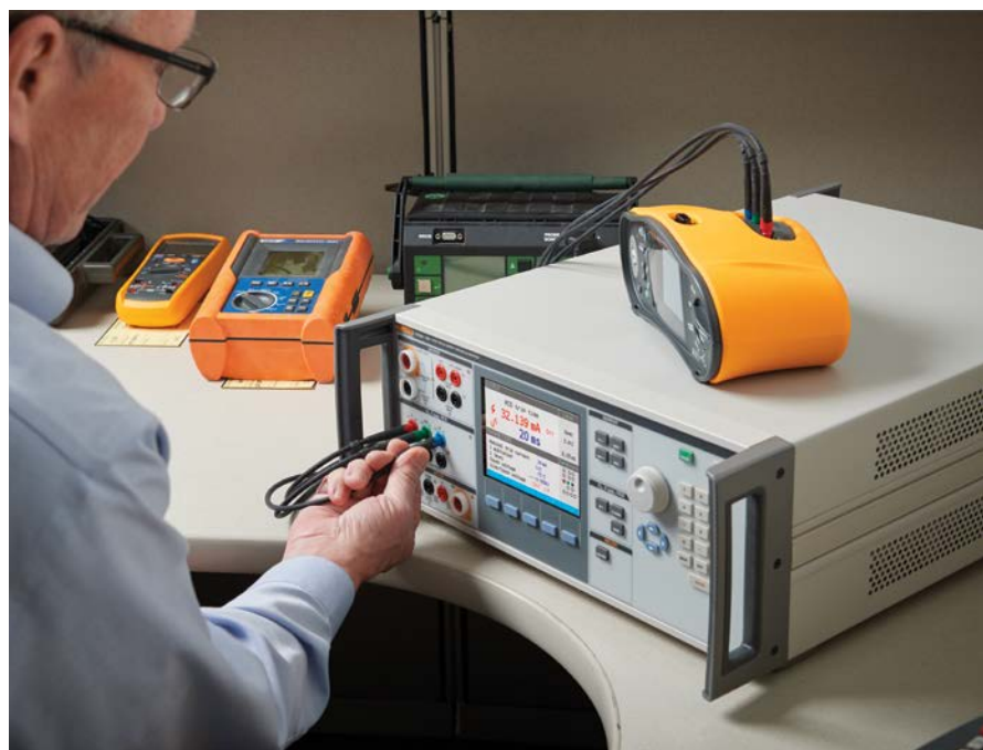
每台 5322A 都配有一个外部 R 倍增器, 用于输出测试绝缘测试仪所需的 10 TΩ 电阻。
