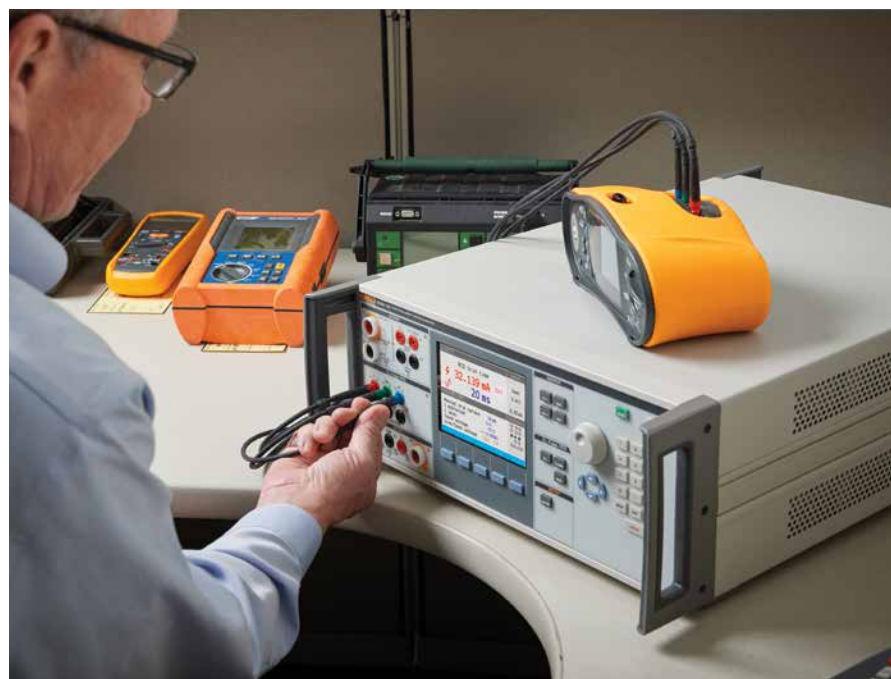
Chaque 5322A est accompagné d'un multiplicateur de résistance externe, pour alimenter les résistances de 10 T Ohms, afin de tester les testeurs d'isolement.
