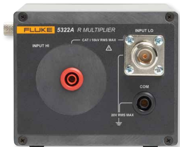
Chaque 5322A est accompagné d'un multiplicateur de résistance externe, pour alimenter les résistances de 10 T Ohms, afin de tester les testeurs d'isolement.
