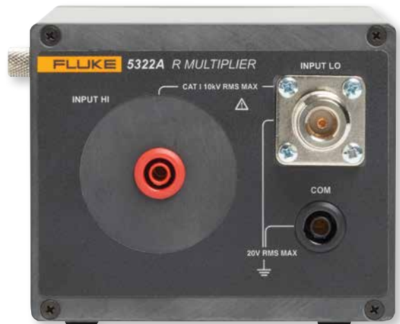
각 5322A에는 절연 테스터를 테스트하기 위하여 10TOhm의 저항에 대한 소성을 하기 위한 외부 R 멀티플라이어와 함께 제공됩니다.
