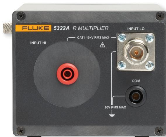
Los 5322A incluyen un multiplicador R externo para generar resistencias de 10 TΩ para probar los comprobadores de aislamiento.
