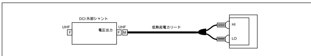
図 17.外部 DC シャントの接続
