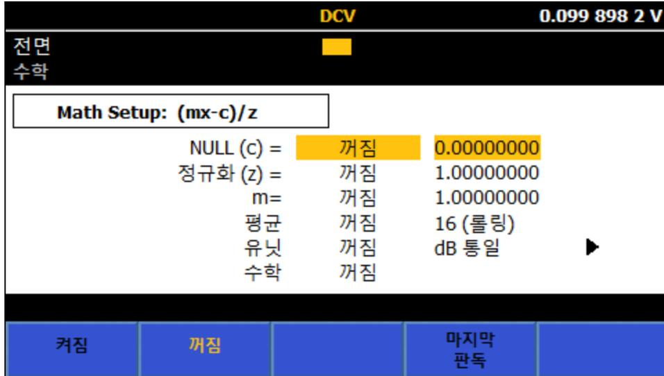
수학 연산은 주요 측정 기능에서 얻은 판독값에 대해 수행됩니다. 수학 기능이 활성화된 경우 표시된 판독값은 산술 설정에 표시된 공식을 기반으로 합니다.  $(mx - c) / z$ . 수식의 "x"는 제품의 단일 측정값 또는 평균 값을 기준으로 한 평균 측정값입니다.
