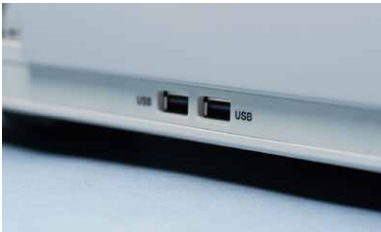
Há portas USB na frente e atrás, para o download de constantes e comunicação com PC remoto.
