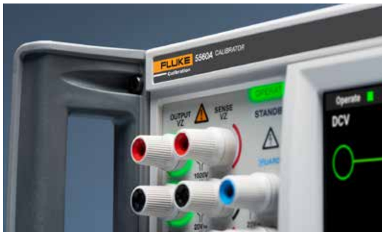
Os terminais de saída com Visual Connection Management orientam o usuário a fazer as conexões corretas.
