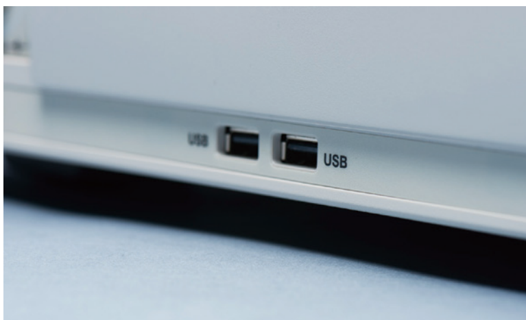
前面と背面に配置された USB ポートは、定数のダウンロードと PC とのリモート通信に利用できます。
