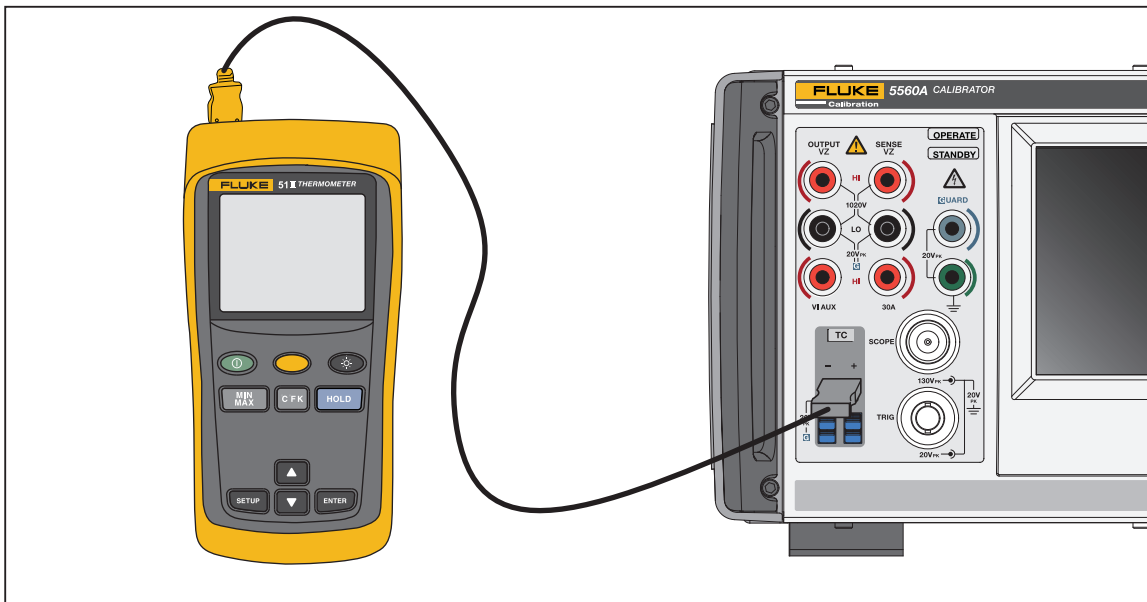
Figure 14. Branchements des câbles pour tester un thermomètre série 50
