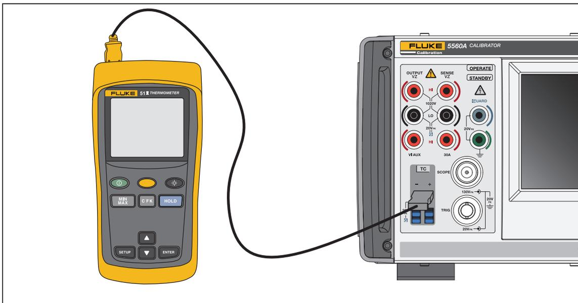
Abbildung 14. Kabelverbindungen zum Testen eines Thermometers Serie 50
