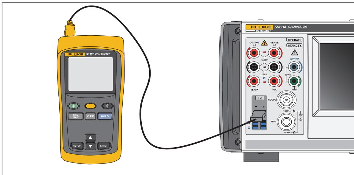
図 10。DUT 接続：温度 (熱電対)
